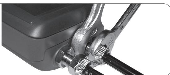
(DK) **FIG3:** Skru omløber fast med fastnøgle. Ved tilspænding skal der holdes kontra på møtrik på manometeret, da man ellers risikerer at beskadige manometerets nippel.
